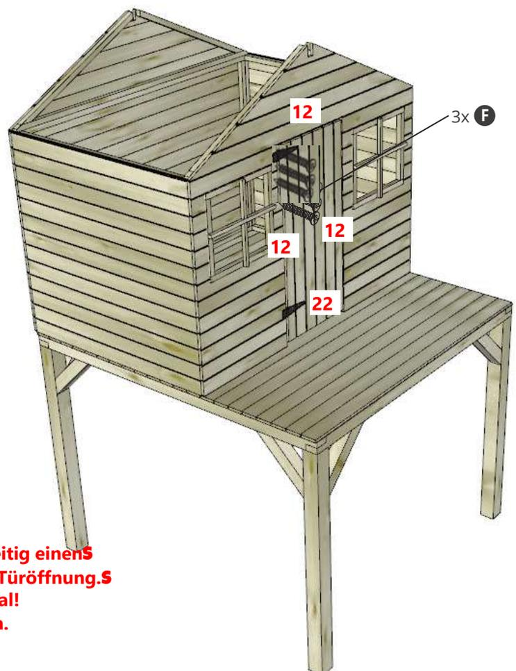
**Um Verletzungen an Fingern zu vermeiden, lassen Sie bei der Montage der Tür oben und beidseitig einen 12 mm gleichmäßigen Spalt zwischen Türblatt und Türöffnung. Dies ist ein vom TÜV gefordertes Sicherheitsmerkmal! Die Tür kann links oder rechts angeschlagen werden.**
