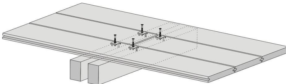
Weiterhin ist die Unterkonstruktion so zu planen, dass die zu verlegenden Dielen **ein Gefälle von 2%** (= 2 cm pro lfdm) in Dielenrichtung erreichen, um einen entsprechenden Wasserablauf zu gewährleisten (Empfehlung).
