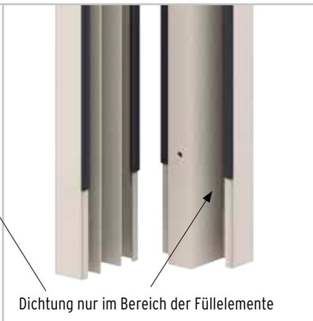
Für GLAS und BOARD die diesen Artikeln beiliegenden Gummidichtungen aufstecken und punktuell an 3 Stellen mit doppelseitigem Kleband fixieren.
